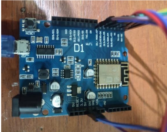
Gambar 6. Arduino Uno Wifi D1
