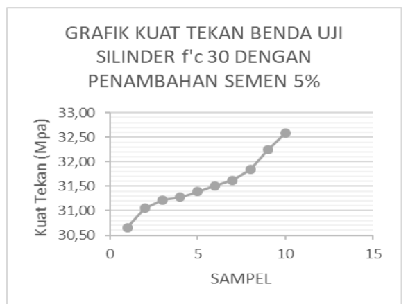
Silinder f'c 30 Mpa Dengan Penambahan Semen 5%
